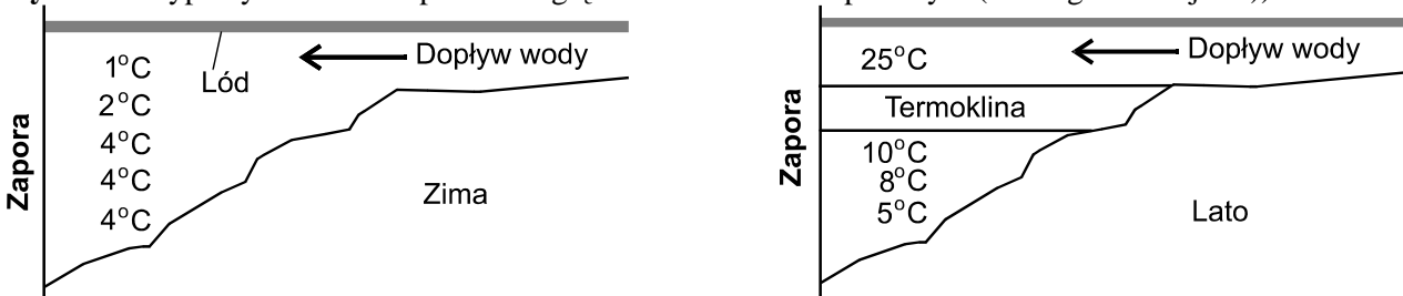
Rys. nr 2. Typowy rozkład temperatur w głębokim zbiorniku zaporowym (według J.R. Dojlido))
